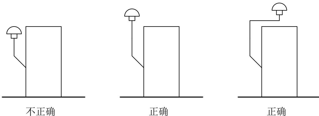
装置应尽量安装在靠近使用时钟信号的装置处，在多个装置使用时钟信号时，装置的安装位置选择原则应尽量减少电缆线的长度。为减少天线连线的长度，以保证接收到的卫星信号具有一定的强度，可使装置安装在靠近天线从建筑物中引出的地方，用电缆把输出信号送到需要同步信号的装置。
